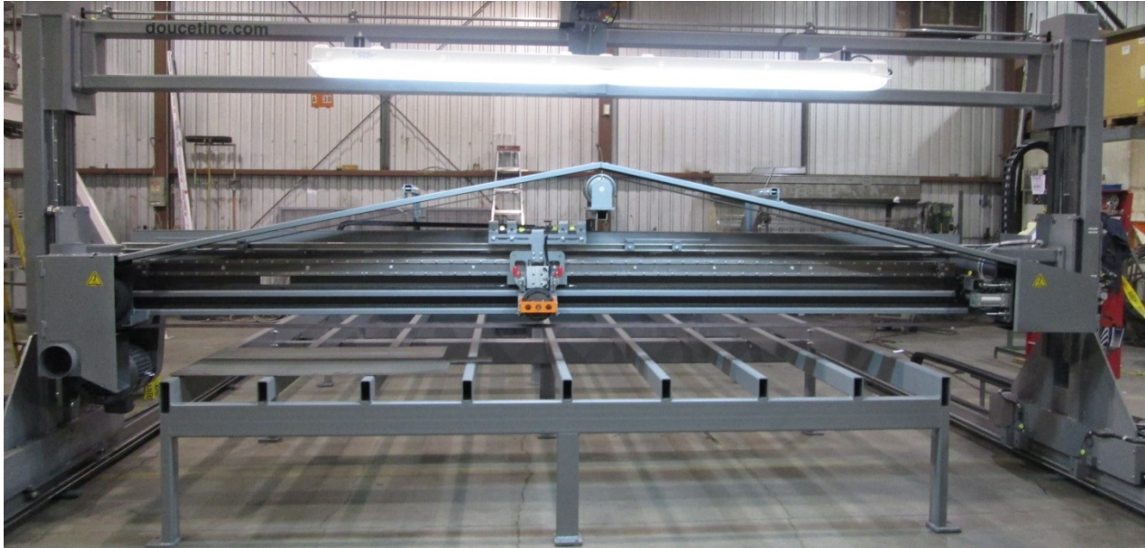
Une ponceuse automatique pour polir des plaques d'acier
