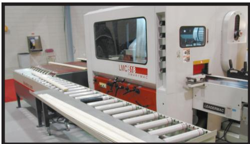
Le MR-8 a une table de réception d'une largeur de 48" et une longueur de 60"; il peut recevoir des moulures jusqu'à 96" de longueur. Tandis que le MR-12 a une table de réception d'une largeur de 48" et une longueur de 84" ; il peut recevoir des moulures jusqu'à 144" de longueur. Le convoyeur de retour pour les 2 modèles a 12" de large et sa longueur est équivalente à la longueur de la moulurière avec laquelle il est jumelé.
