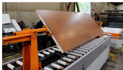
LE DTF-360 PIVOTANT UNE PORTE POUR INSPECTION
