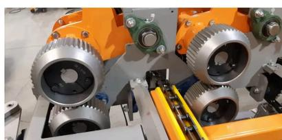
MFE-300 - ROUES D'ALIMENTATION EN ACIER AVEC SURFACES TREMPÉES ET COCHÉES
