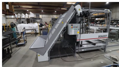
EMPILEUR À LATTES AUTOMATIQUE ET PANNEAU DE CONTRÔLE ÉLECTRIQUE
