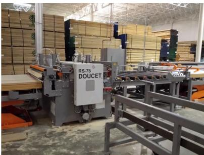
ENSEMBLE D'ENTRÉE, RS-75 ET CONVOYEUR DE SORTIE
