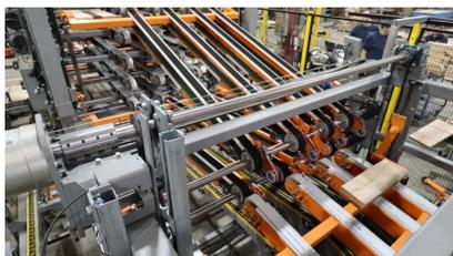
SYSTÈME D'AIGUILLAGE À DEUX BRAS AVEC SERVOMOTEUR
