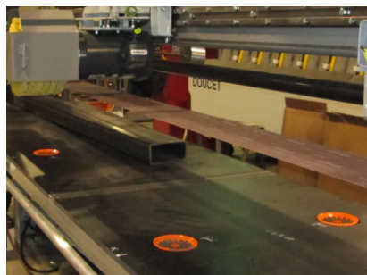
VACUUM À SIX (6) VENTOUSES AVEC BOUTON D'ACTIVATION INDIVIDUEL, POUR TENIR LES PIÈCES
